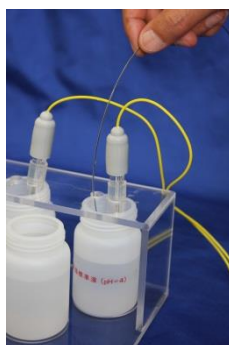
a) pH 電極を pH4.01 標準液に浸漬させる
