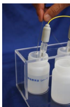
a) pH 電極を pH6.86 標準液に浸漬させる
