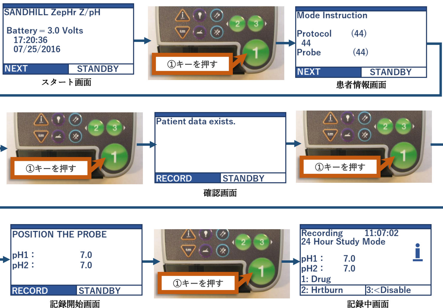
図 70 電池交換後の測定の再開までの流れ
